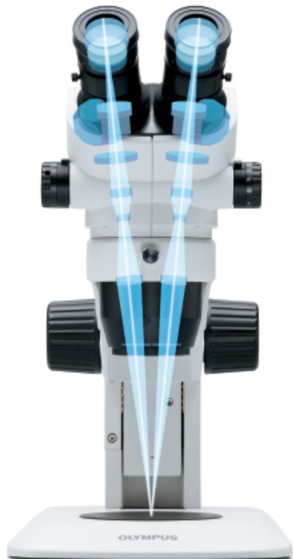
Das optische System nach Greenough besitzt zwei Strahlengänge, die zueinander geneigt sind. Dies ermöglicht eine besonders kompakte Bauart bei hoher Funktionalität.
