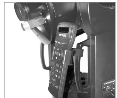
Abb. B: Handbox-Halter, am Gabelarm angebracht. Der Winkel kann nun justiert werden.
