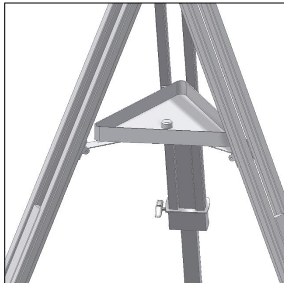
Figura 3. Colocación de la bandeja.
