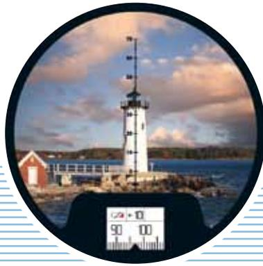
Die integrierte elektronische Magnetfeld-Messung sorgt überall auf der Welt für eine absolut präzise Peilung, vom Polarkreis bis in die Südsee. Die analoge Anzeige am unteren Bildrand zeichnet sich durch eine hohe Ablesefreundlichkeit aus, ohne im Sehfeld zu stören. Dank der intuitiven Bedienung und der automatischen Kompensation der Neigung ist die Handhabung einfach und zuverlässig.
